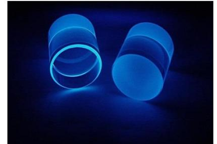
Anfang des 20. Jahrhunderts wurde das Leuchten des Kristalls mit bloßem Auge verfolgt, heute wird das entstehende Licht mit Lichtdetektoren aufgrund des lichtelektrischen Effektes detektiert. Ein modernes **Szintillationsdetektor** besteht also aus zwei Bestandteilen: aus einem *Szintillationskristall* (auch Szintillator genannt) und einem *Photomultiplier* als Lichtdetektor.
